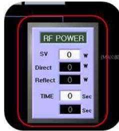
6) 공정이 완료된 후 OFF 순서는 역순으로 진행, RF Power OFF이후 T/V 100% Open 상태로 전환하여 챔버 내부에 잔류하고 있는 가스를 제거 합니다.
