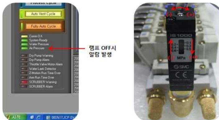
2) 레귤레이터 압력이 4Mpa로 사용하실 경우 Air pressure sensor를 4Mpa로 설정하여 사용하시면, 잦은 Air pressure 알람이 발생할 수 있으므로, 레귤레이터 압력이 0.4Mpa로 사용한다면 Air pressure sensor 범위는 0.4Mpa 이하 (약 0.3~0.35Mpa)로 설정하여 사용하시기 바랍니다.
