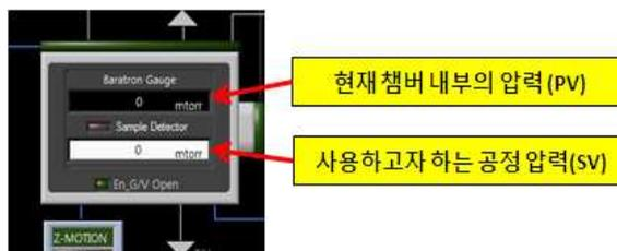
4) 공정 압력값 입력 후 Throttle valve의 Pressure mode를 이용하여 현재 챔버 내부의 압력값을 변경합니다.
